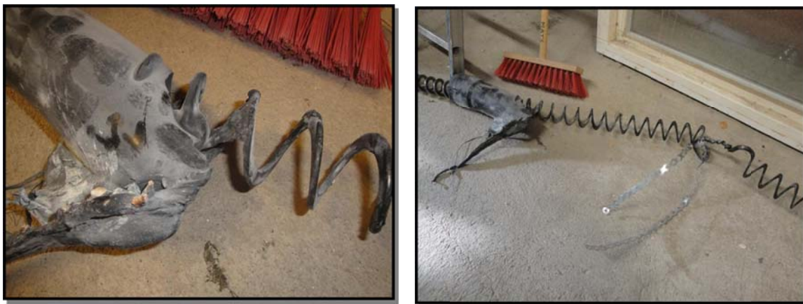
Bild 5 Rester av nedsmält transportrör och söndervriden pelletsskruv. Felet orsakade brand som kunde släckas innan större skada uppstod. (Foto U. Svedberg).
